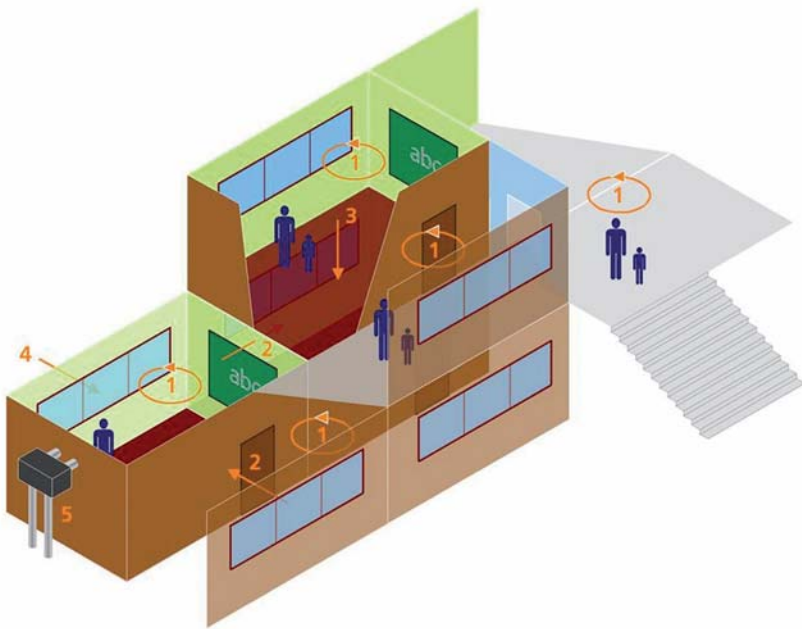
Bild 2: Raumakustische (1 - Nachhallzeit) und bauakustische (2 - Schallschutz von Wänden etc., 3 - Trittschallschutz von Decken, 4 - Schallschutz von Außenbauteilen, 5 - Geräusche von haustechnischen Anlagen) Einflüsse auf die Qualität von Schulgebäuden
