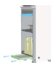
Vorfilter über die Führungsschienen verschieben und entnehmen.
