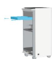
Die 4 Klemmen lösen, die an den Ecken des Absolutfilters angebracht sind, um ihn über die Schienen bis zum Anschlag herausnehmen zu können.
